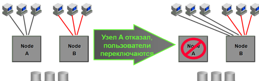
Рис. 11. Автоматическое переключение пользователей после сбоя узла
